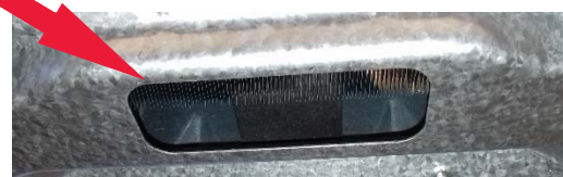
A KIVEZETŐCSONKOT IS FŰTI A KONDENZÁTORHŐ
