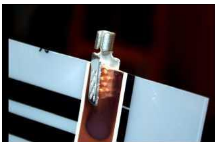
02. Ezüst csatlakozó beszúrása a film és rézcsík közé elől nézet
