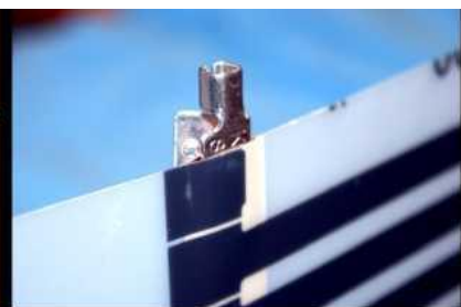
02. Ezüst csatlakozó beszúrása a film és rézcsík közé hátul nézet
