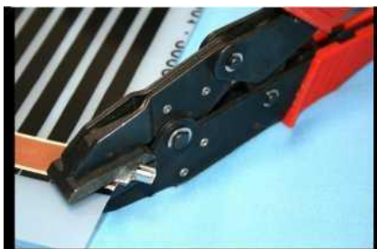
03.1 Ezüst csatlakozó és az elektromos kábel csatlakoztatása speciális présfogóval
