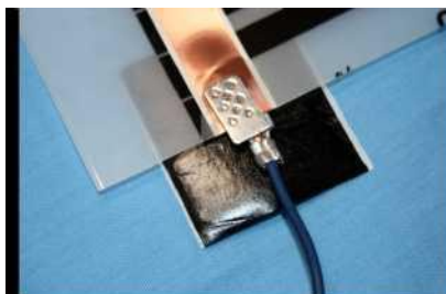
04. 3 Vízhatlan szigetelő tapasz rögzítése alulról
