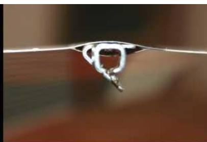
02. Ezüst csatlakozó beszúrása a film és rézcsík közé felül nézet
