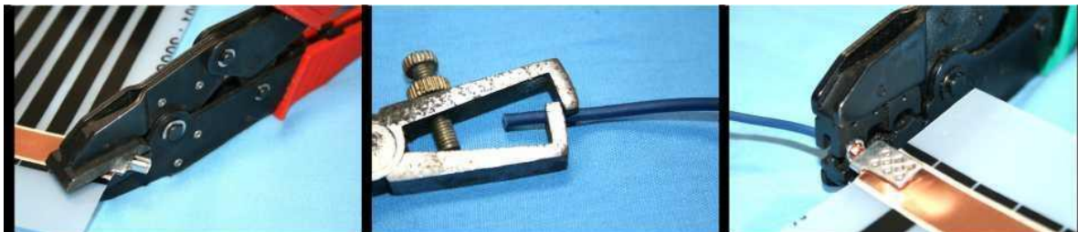
3.1 Ezüst csatlakozó és az elektromos kábel csatlakoztatása speciális présfogóval
